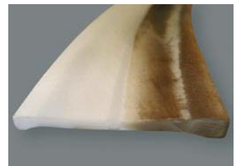
Querschnitt eines GORE® Dichtungsbands Serie 1000 nach Einsatz unter schwierigen Prozessbedingungen
